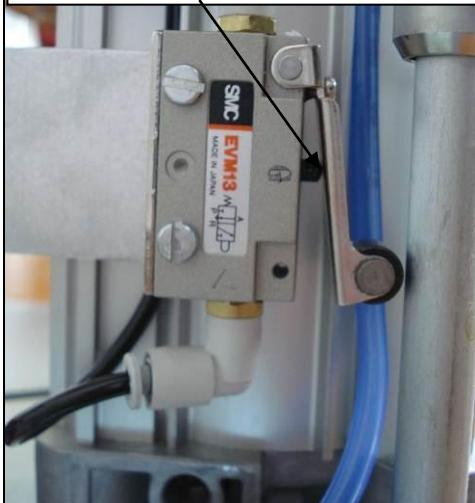
Oberer Endschalter (X) betätigt. Anlage läuft im Förderbetrieb und mit Zweihand-Steuerung.
